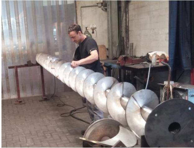
Wir führen Schneckenreparaturen jeglicher Art professionell für Sie durch. Auch Schnecken-Ersatzteile für Fremdfabrikate wie z.B. SKIOLD (Dameco), SVEA, Neuero, President usw. haben wir auf Lager oder können diese für Sie fertigen.
