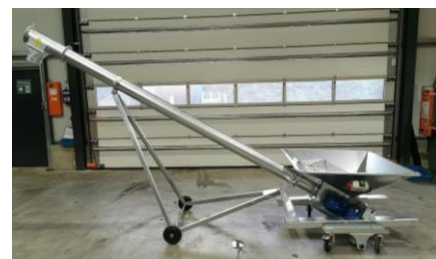
Fahrbare Stütze mit Trichter 1,36x1,16m
