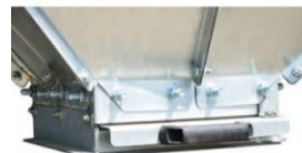
Auslauf mit Absperrschieber
