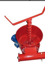
Schneckenkasten mit Rührwerk für schwerfließende Güter
