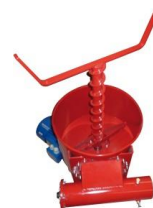
Schneckenkasten mit Rührwerk
