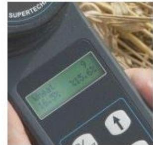
Die ON/TEST-Taste drücken, und den Feuchtigkeitsgehalt direkt vom Display ablesen.
