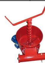
Schneckenkasten mit Rührwerk für schwerfließende Güter
